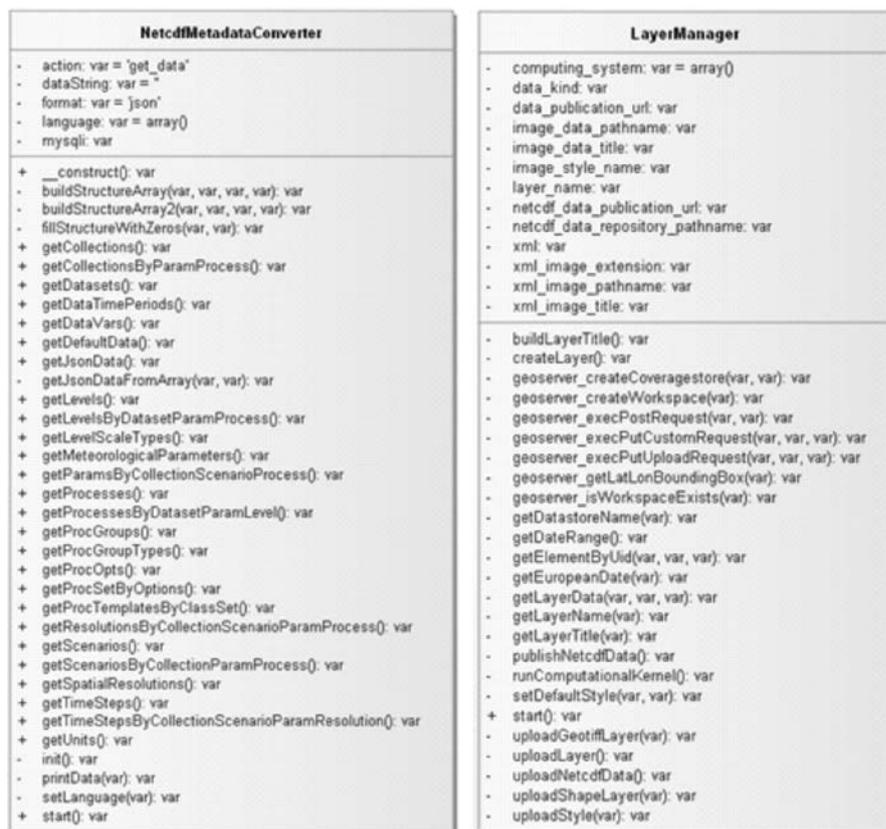
Рис. 2. UML диаграммы классов LayerManager и NetcdfMetadataConverter
