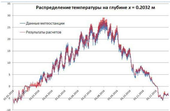
**Рис. 3.** Распределение температуры на глубине  $x = 0,2032$  м
