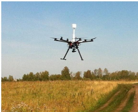
Автоматическая метеостанция на платформе гексокоптера
