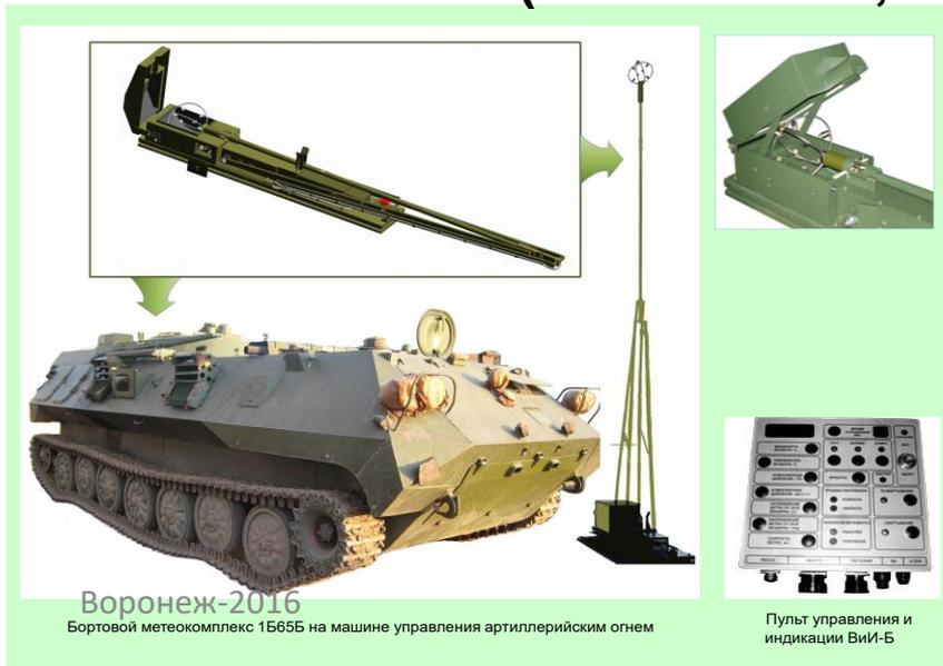
Воронеж-2016 Бортовой метеокомплекс 1Б65Б на машине управления артиллерийским огнем
