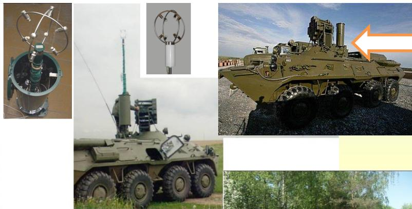
Бортовой метеокомплекс БМК-01 со звуковещательной установкой на шасси бронетранспортера
