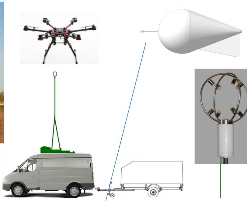
Автоматическая метеостанция на платформе привязного аэростата гибридного типа.
