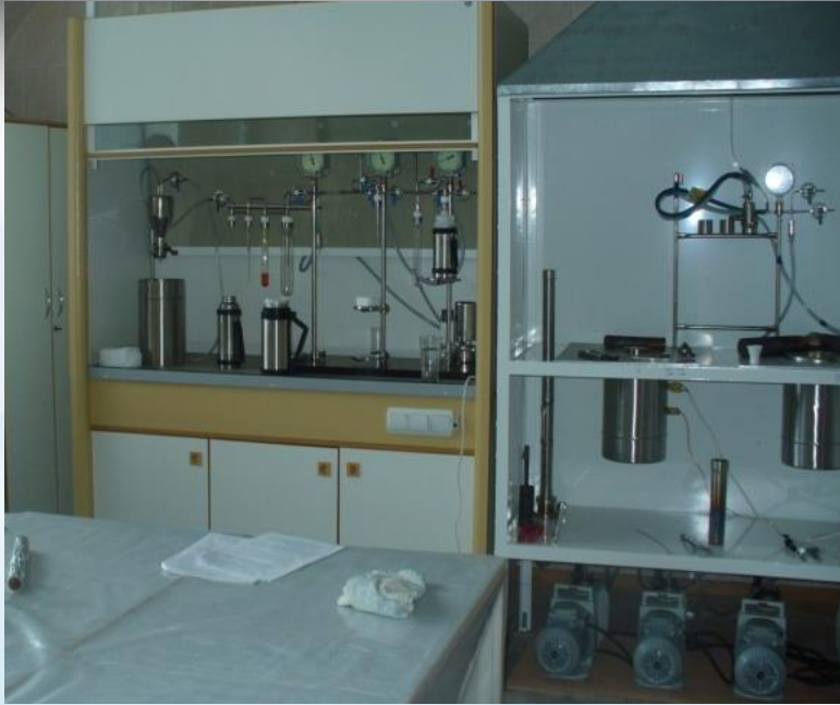
Установка синтеза бензола
