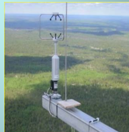
Ультразвуковой 3-D анемометр Gill R3-50 Sonic, фирма-изготовитель Licor, США
