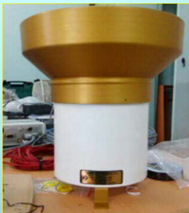
Автоматический измеритель осадков "TR-525M Tipping Bucket", фирма-изготовитель Electronics, Inc., США;
