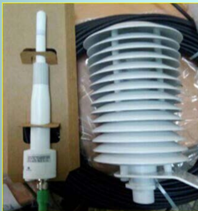
Датчик температуры и влажности воздуха Vaisala HMP155, фирма-изготовитель Vaisala Oyj, Финляндия
