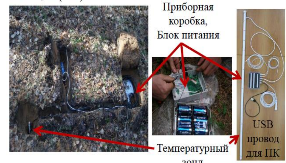
Устройство атмосферно-почвенного измерительного комплекса (антивандальная комплектация).
