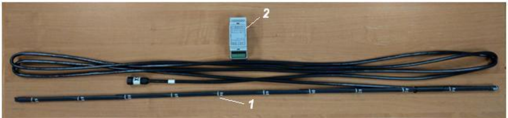
Внешний вид: 1 – линейка датчиков; 2 – электронный блок
