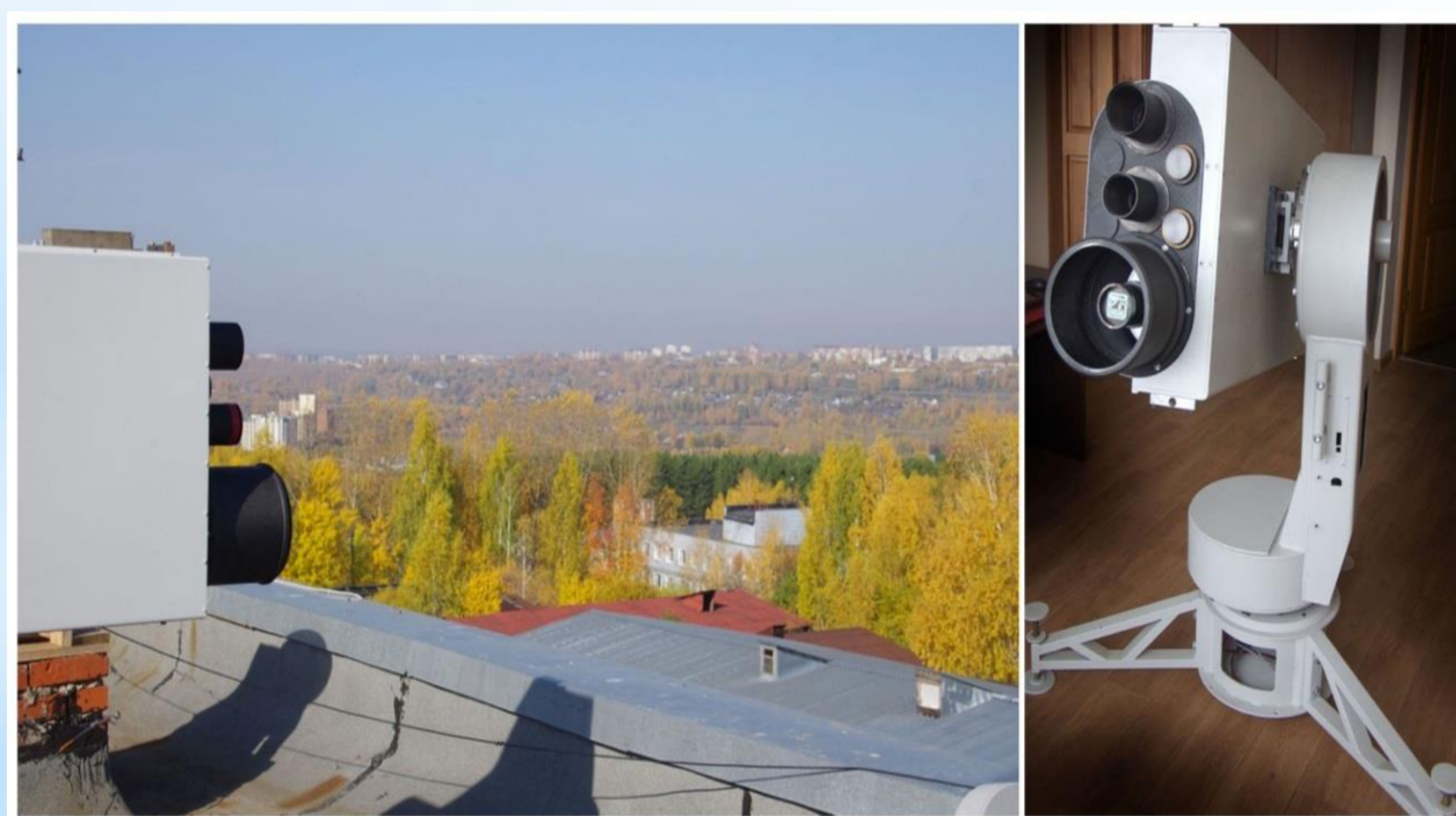
Рис. 2. Внешний вид лидара «ЛОЗА-М3», установленного на крыше Блока «А» Института оптики атмосферы (слева) и внешний вид лидара (справа)
