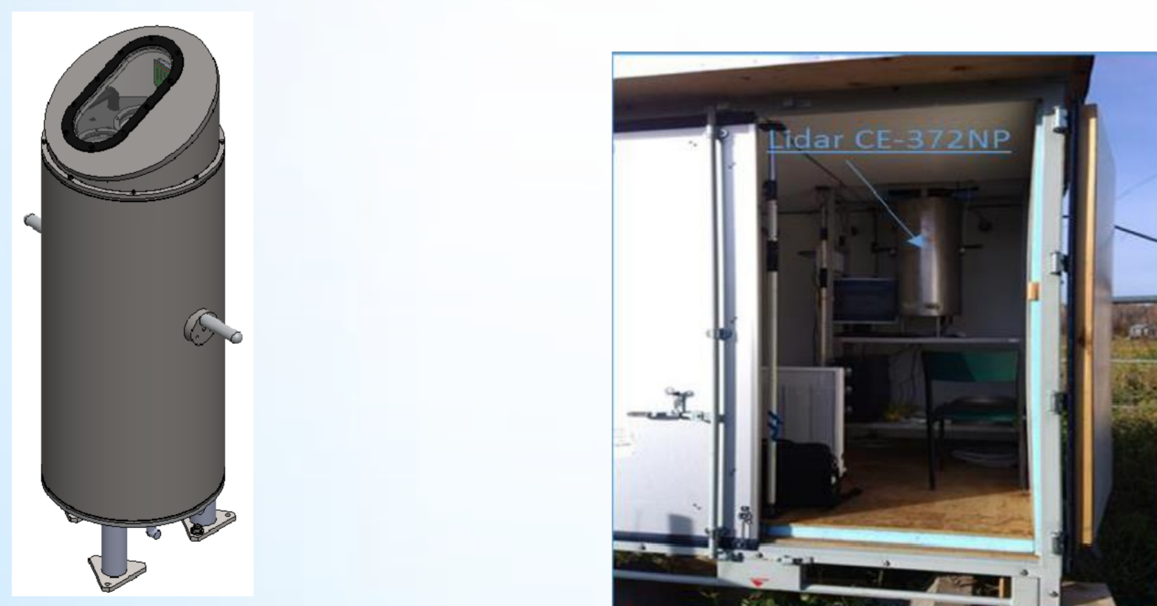
Рис. 3. Внешний вид лидара CE-372NP (слева) и фото лидара, установленного в термостабилизированный контейнер (справа)
