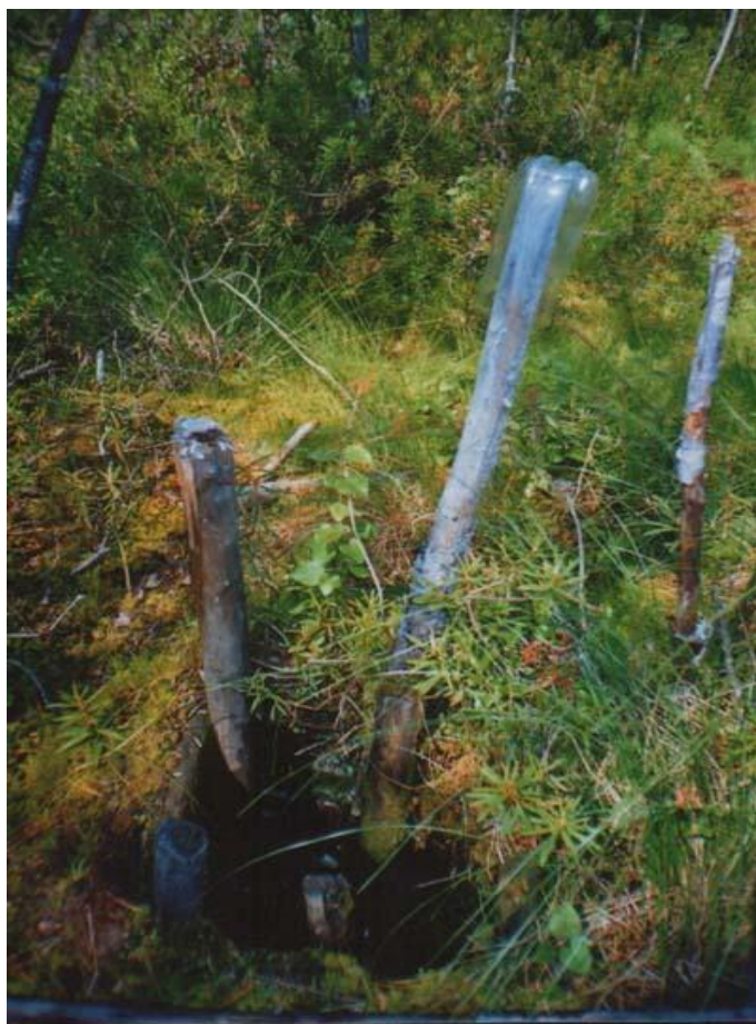
Рисунок 6. Колодец для измерений уровней болотных вод
