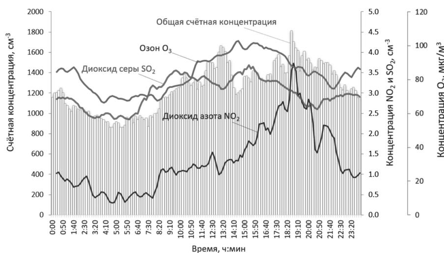
**Рис. 3.** Суточный ход усредненных десятиминутных значений общей счетной концентрации высокодисперсной фракции аэрозоля, диоксида азота  $\text{NO}_2$ , озона  $\text{O}_3$  и диоксида серы  $\text{SO}_2$  на ст. Боярский (13.08-10.09.2020).
